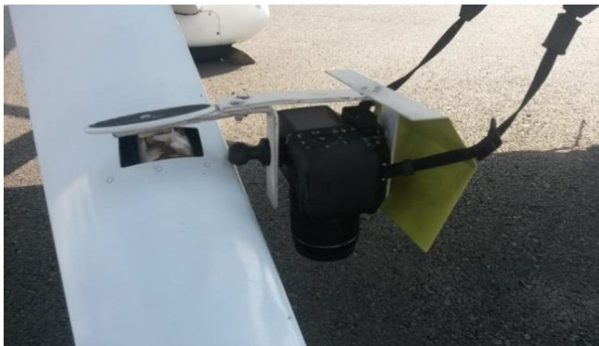
Figura 1. Instalación del soporte para la cámara en la aeronave Cessna 182
