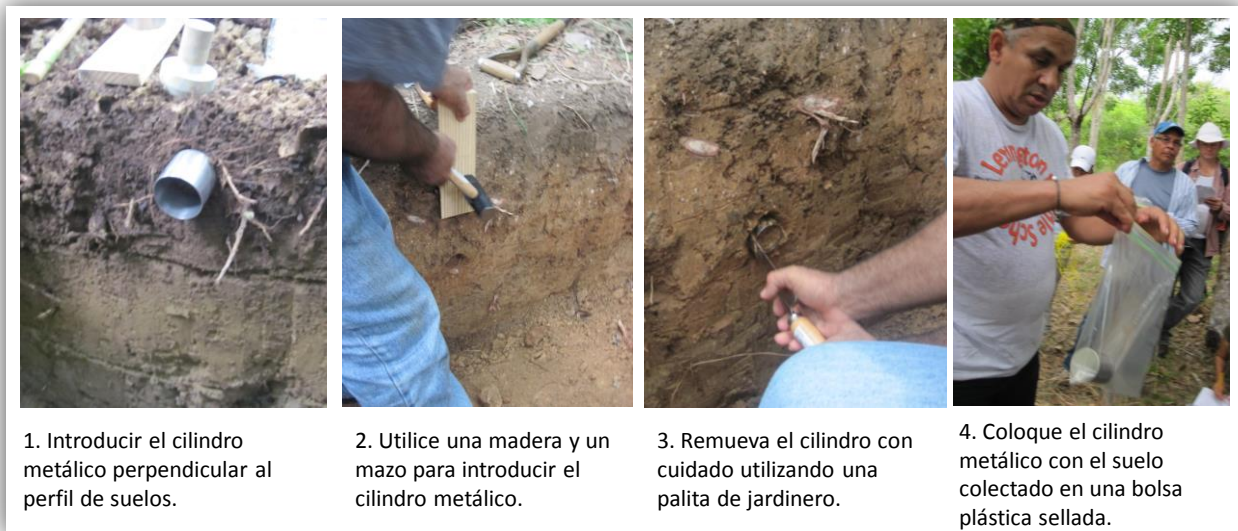
Figura 11. Pasos para recolectar las muestras de suelo para medir densidad aparente y carbono orgánico de suelos en las calicatas.
