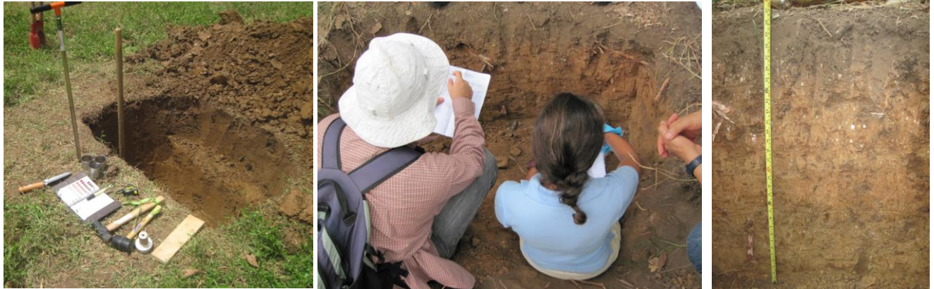
1. Materiales para realizar una calicata.
