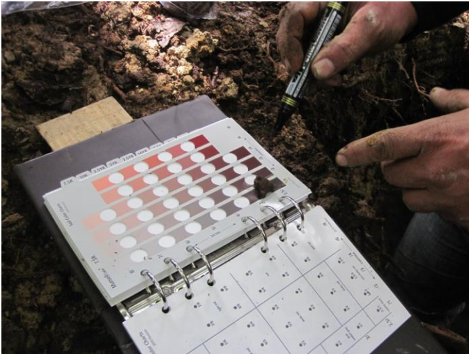
Figura 10. Demostración para determinar el color de suelo y moteado.
