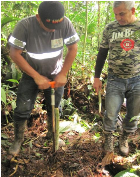
Recolección de muestra de 0 – 30 cm de profundidad utilizando el barreno.
